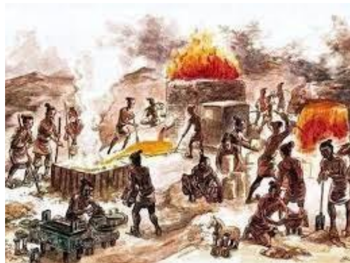
古代青铜冶炼，根据火焰颜色判断炉温高低
